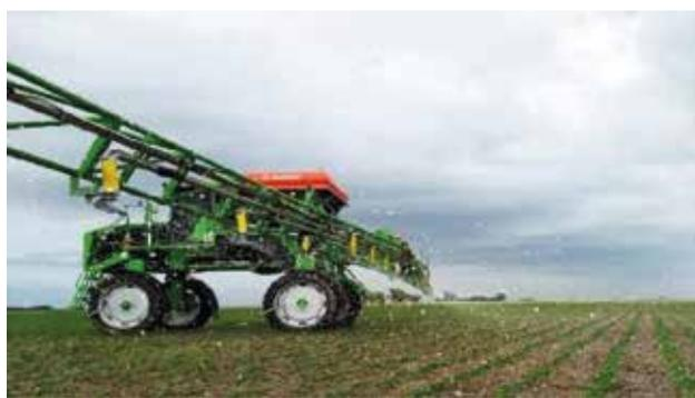
Estas máquinas aplicadoras de fertilizantes cuentan con una tolva dónde se carga el producto (fertilizante), un sistema de dosificación y una turbina de aire que genera una corriente de aire de gran velocidad que permite distribuir los gránulos de fertilizante o de cebo a través de un determinado número de tubos de salida con descargas sobre el terreno.
