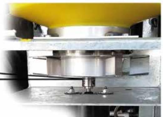
Además del disco giratorio que es el componente más importante del equipo, las aplicadoras de cebos cuentan con una tolva de alimentación, generalmente entre 30 y 50 kgs de capacidad y un sistema de dosificación (a motor) o de alimentación por gravedad en los modelos más sencillos.
