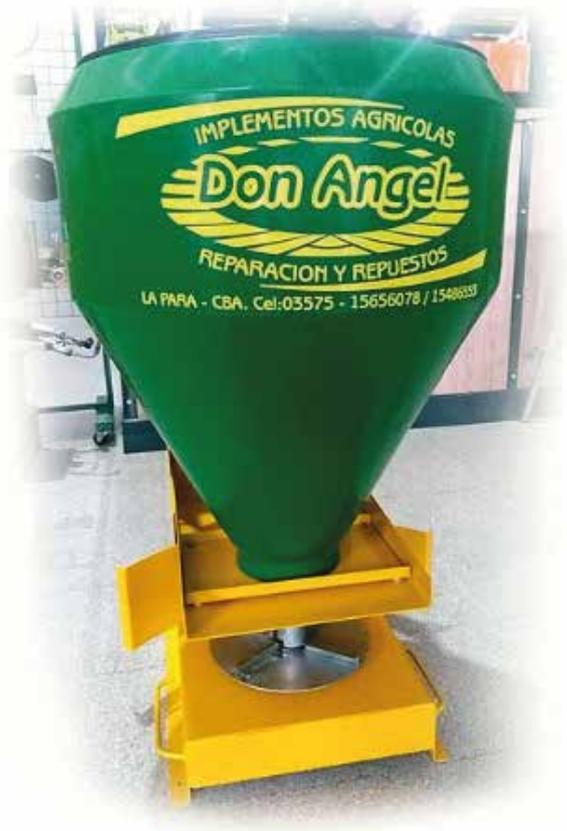
Los fabricantes cuentan con información que permite regular el flujo de estos dosificadores (a motor o por gravedad) de manera de poder acceder a una aplicación acorde a las dosis que generalmente se recomiendan para este tipo de productos, en un rango que puede variar entre 1,5 a 10 kgs por hectárea.
