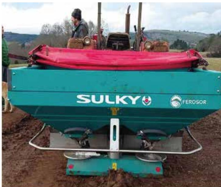
Estos discos, suelen tener sistemas mecánicos, o hidráulicos, a diferencia de los eléctricos de las aplicadoras portátiles.
